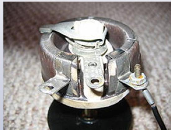
Resolusi alat tergantung pada lebar penggesek, diameter kawat resistor dan jarak antar Jilitan.
